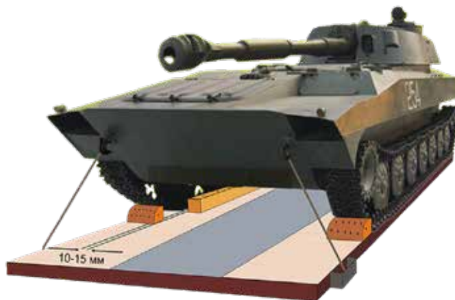
Рис. 23. Кріплення військової гусеничної машини від поперечного переміщення бічними брусками
