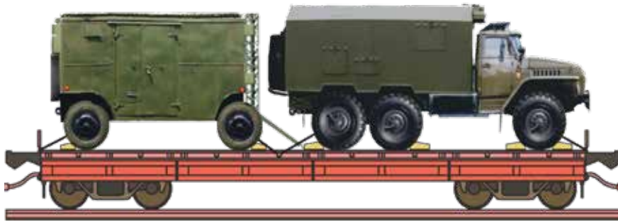
Рис. 15. Закріплення колісних машин другим способом
