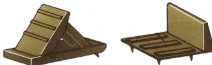
Рис. 9. Комплект універсальних багатообертових кріплень (УБК-1К, УБК-2К) для кріплення військових колісних машин
