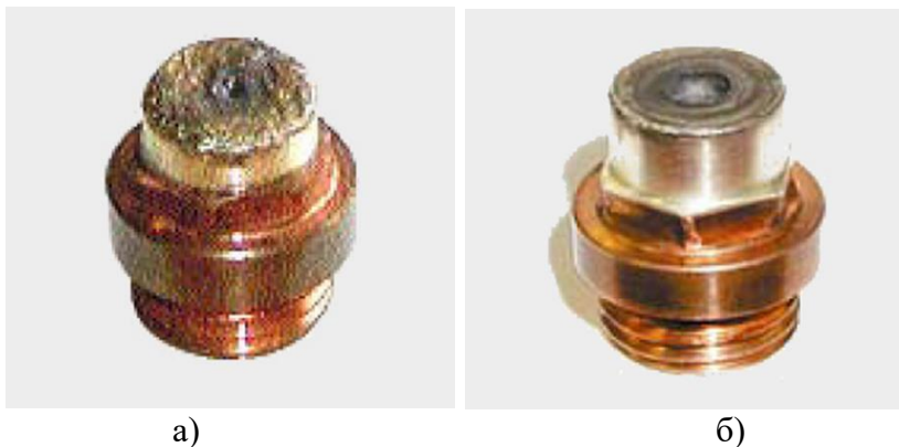
Рис. 17. Зовнішній вигляд розрядних електродів після електричного вибуху свинцевого (а) і вольфрамового (б) провідників
