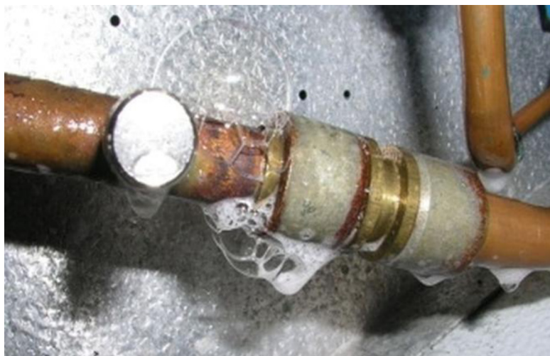
Рис. 8. Перевірка герметичності з'єднання методом обмилування
