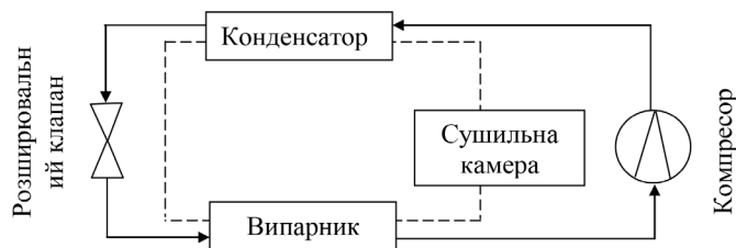
Рис. 1. Розташування компонентів сушарки з тепловим насосом
