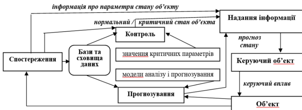
Рис. 1. СЛФС процесів інформаційної підтримки прийняття рішень з використанням ІТС
