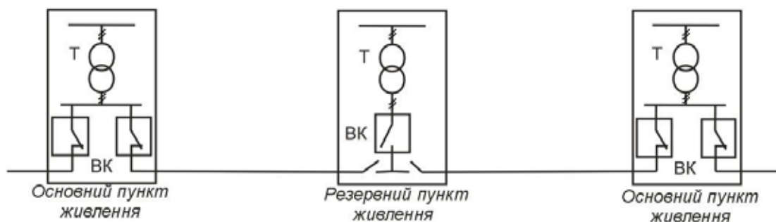
Рис. 3. Схема електроживлення ВЛ СЦБ при змішаній системі
